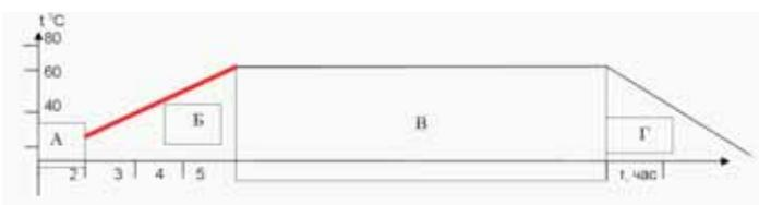
Рис. 1 Диаграмма пропарки железобетонных изделий
