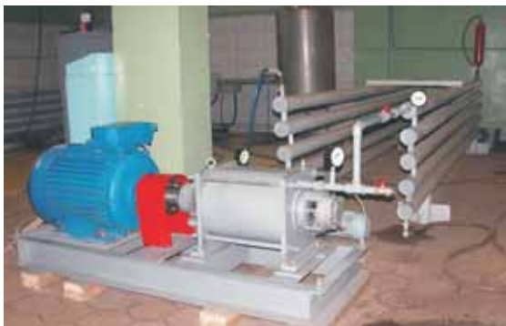
Фото 1. Тепловой гидродинамический насос
