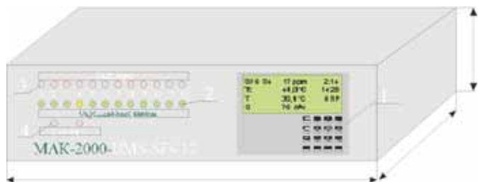
Внешний вид газоанализатора «МАК-2000-UMS-SF6-12»
