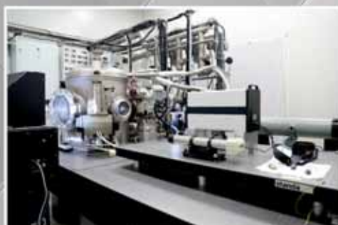
Рис. 1 Стенд с ТБК для контроля параметров оптических элементов и узлов
