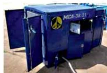
Газоразделительный блок азотной установки
