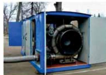
Газотурбинная компрессорная установка ГТКУ М10/21
