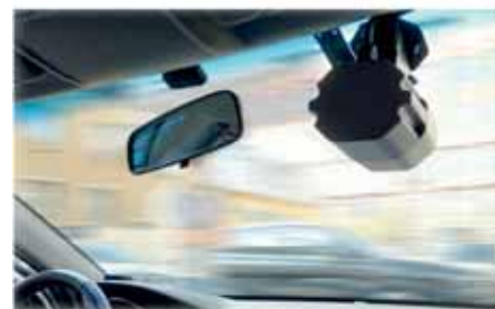
Размещение видеоблока для контроля скорости через лобовое стекло патрульного автомобиля.
