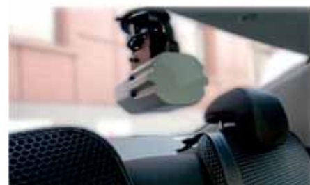
Размещение видеоблока для контроля скорости через заднее стекло патрульного автомобиля.
