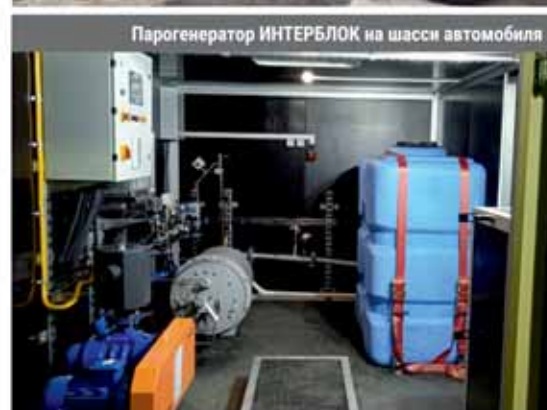
Комплекс разморозки смёрзшихся насыпных грузов в ж/д полувагонах
