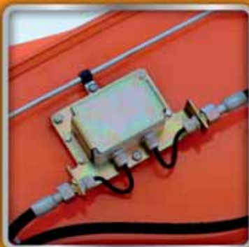
Датчик угла наклона рукояти
