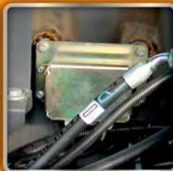
Датчик угла наклона поворотной платформы
