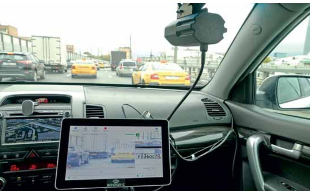
Размещение ИК-прожектора для работы комплекса в тёмное время суток.
