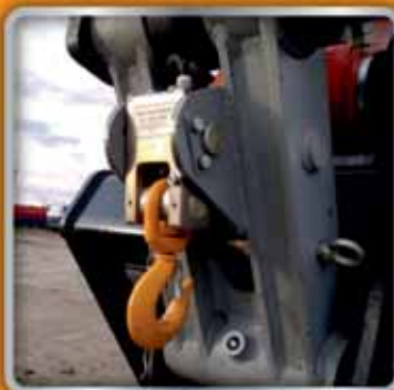
Крюковая обойма с датчиком нагрузки
