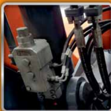
Гидрозамок на гидроцилиндре подъёма стрелы
